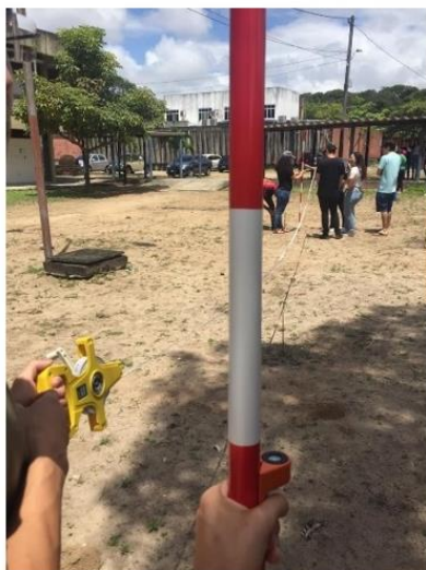
Figura 1: Alunos realizando estaqueamento para aferir o passo médio
