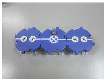
Fig. 30 Módulo utilizado para medir resistência elétrica da lâmpada.
